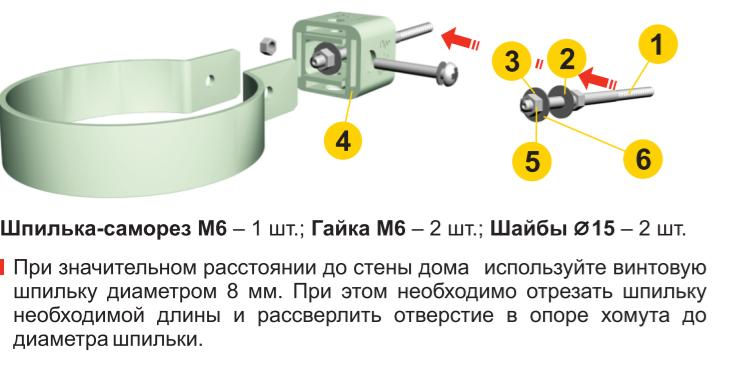
Шпилька-саморез M6 – 1 шт.; Гайка M6 – 2 шт.; Шайбы Ø15 – 2 шт.
